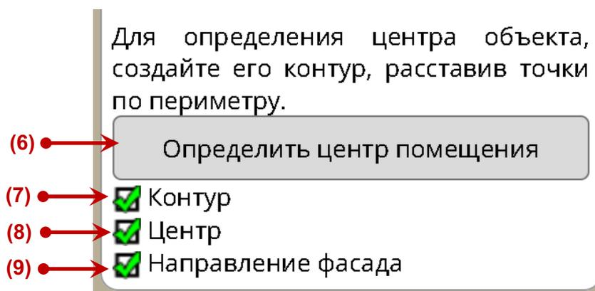
**(6)** – Активация и деактивация функции создания контура и определения центра.
